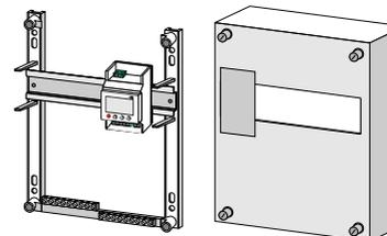
T1C-2 digit se monta sobre rail DIN en armario eléctrico
